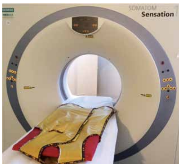
Abb. 2: Röntgenschürze auf dem Tisch positioniert. Für die Schürzenprüfung bei einer a-p- Röhrenposition, muss der Tisch auf die niedrigst-mögliche Tischhöhe eingestellt werden.
