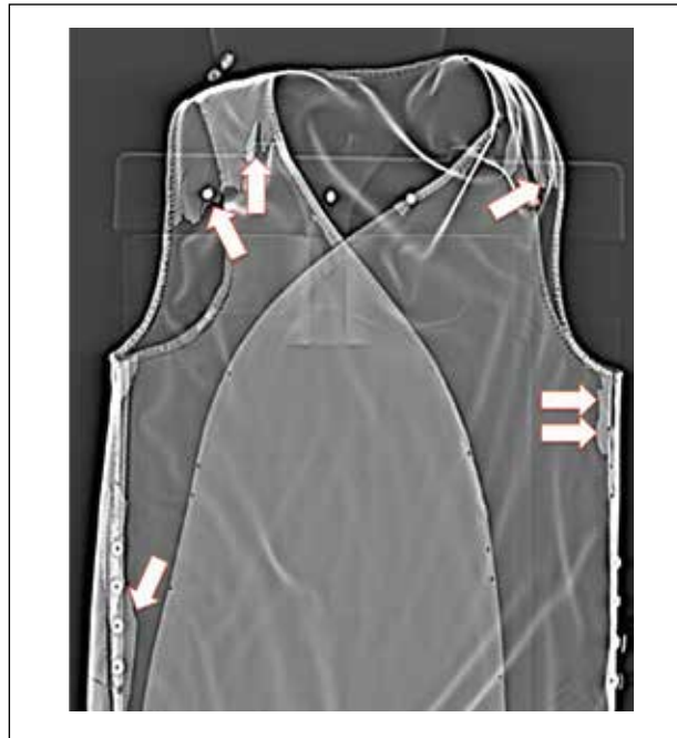
Abb. 5a: Röntgenschürze mit Mängeln. Pfeile markieren die Abrisskanten des Schutzmaterials
