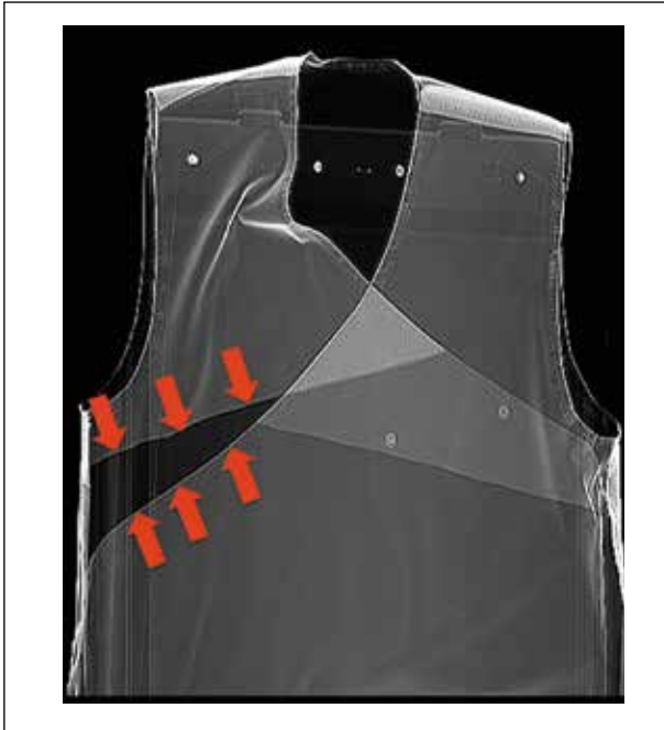
Abb. 6: Neue Röntgenschürze, die exakt angezogen werden muss, um ihre vollständige Schutzwirkung zu entfalten
